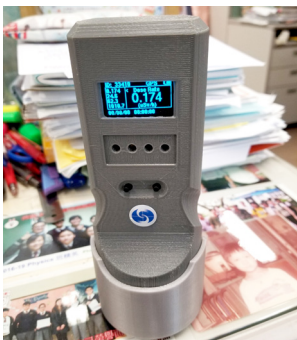
天文台贈送本校的自家設計3D打印「伽馬線報」便攜式裝置，供物理學會幹事在各區不同地方測量伽馬輻射及氣象數據。
